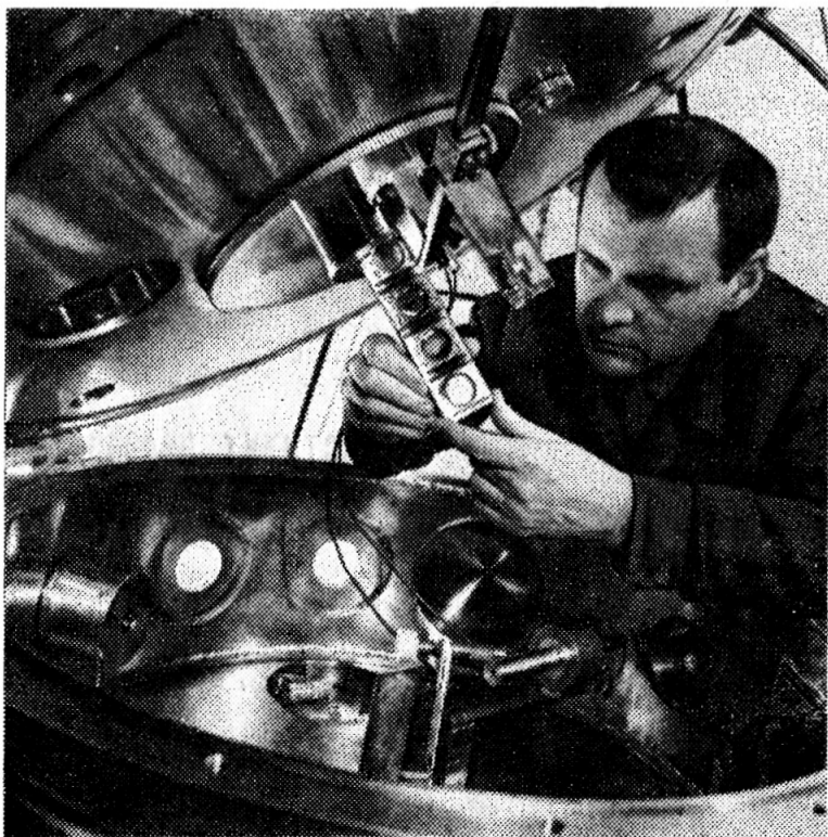
Научный сотрудник сектора А. Г. Артюх устанавливает мишень в реакционной камере магнитного анализатора.
