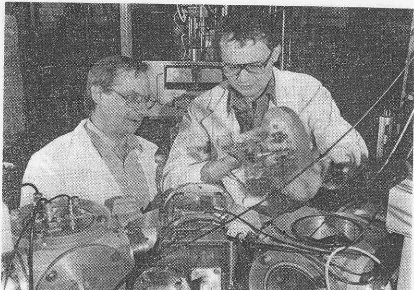
В Лаборатории ядерных реакций ведутся эксперименты по изучению характеристик низзоэнергетического деления ядер в реакциях с тяжелыми ионами. Точная идентификация продуктов реакции проводится на двухплечевом времяпролетном электромагнитном спектрометре ДЭМАС за счет отбора событий по углу с одновременным измерением углов разлета продуктов, их энергии и времени пролета. Такая ме-
