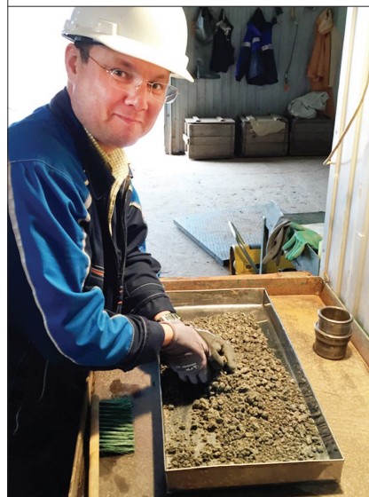
Визуальный просмотр отобранного концентрата в полевых условиях.
