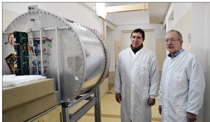
С. А. Мовчан и О. В. Фатеев около прототипа время-проекционной камеры, выполненного в масштабе 1:3.
