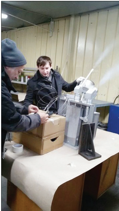
Проверку работоспособности термопар жидким азотом ведут А. П. Сиротин и К. А. Мухин.
