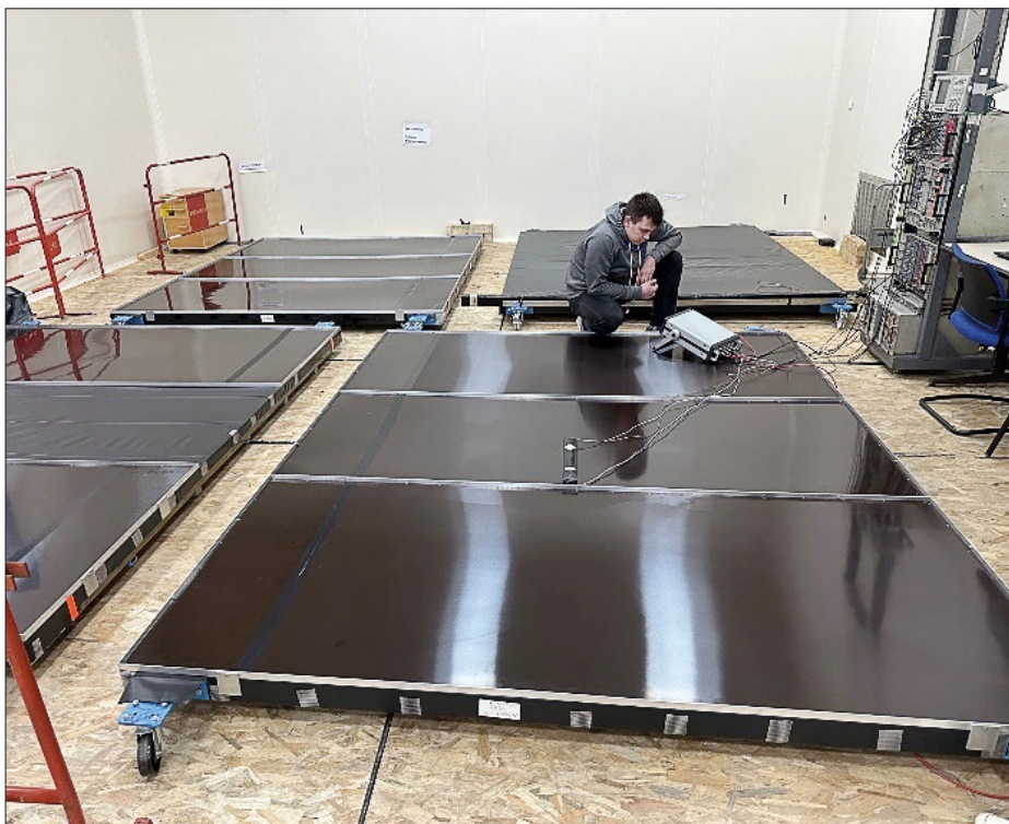
В. В. Устинов настраивает триггерные плоскости стенда для измерения характеристик кассет адронного калориметра
